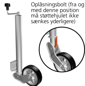
Automatisk støttehjul (grovjustering via klappmekanisme og spindeldrev)
